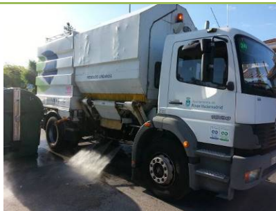
Camión lavacontenedores de carga lateral con sistema de limpieza de recintos
