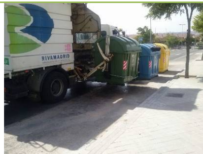
Camión lavacontenedores de carga lateral con sistema de limpieza de recintos
