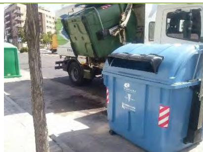
Camión lavacontenedores de carga lateral con sistema de limpieza de recintos
