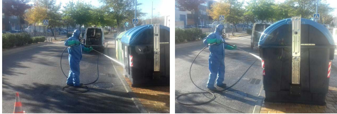
Limpeza de contenedores y recintos con agua caliente a presión
